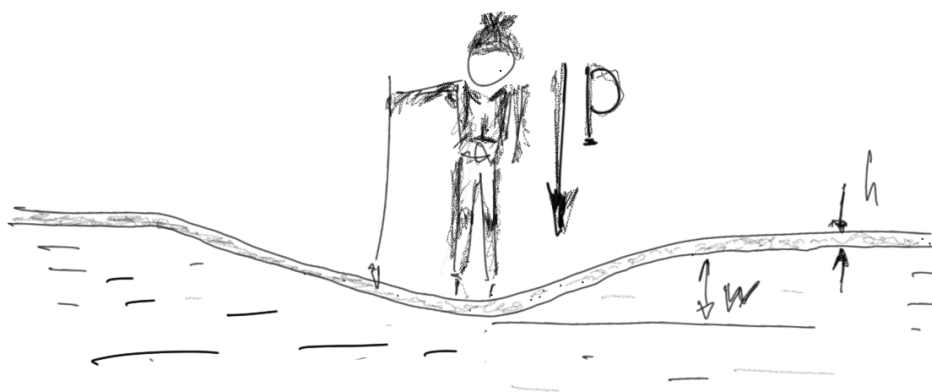
Рисунок 3. Прогиб льда под нагрузкой
