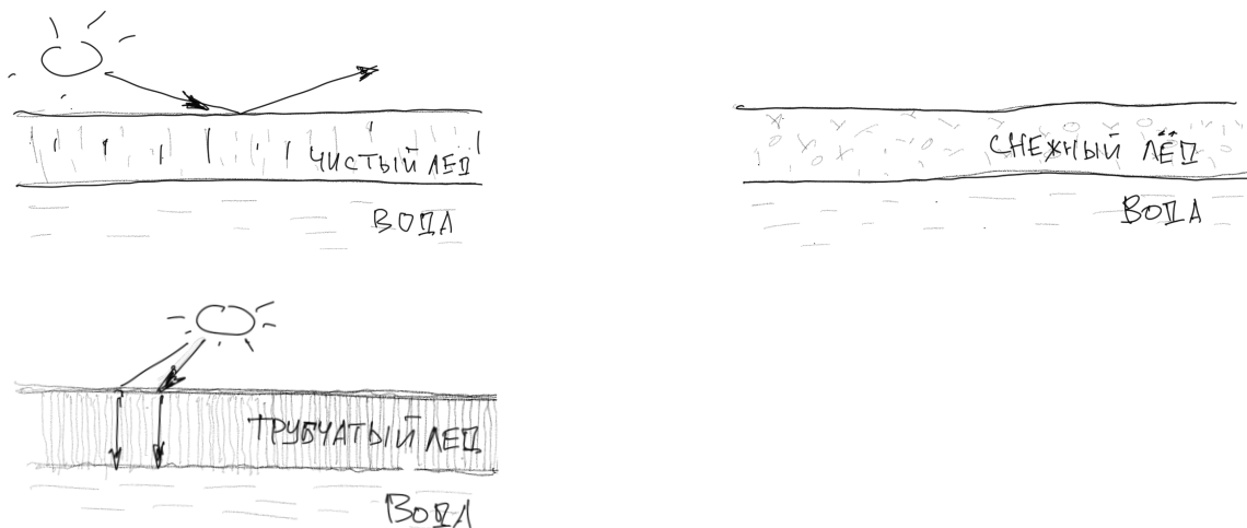
Рисунок 1. Структуры льда: 1) чистый плотный (черный, голубой) лед, 2) снежный пористый (серый) лед, 3) карандашный или трубчатый (темно-серый) весенний лед
